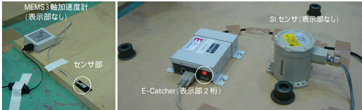
写真2 MEMS3軸加速度計, E-Catcher および SI センサの取付状況
