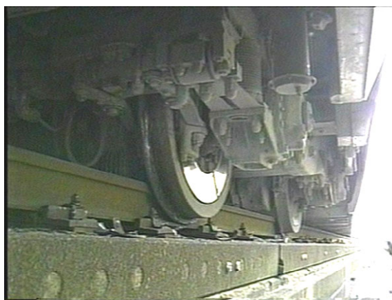
2号車（後から2両目）3号車寄り台車の状況、車輪がレールに密着していること、胴体がレールに接触していることなどが分かる。（NEWS23取材班提供VTRから）
