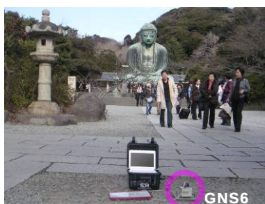
写真1 地盤での微動測定
